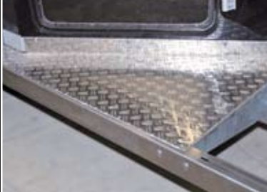
Beidseitig Tritte aus Aluminium- Riffelblech
