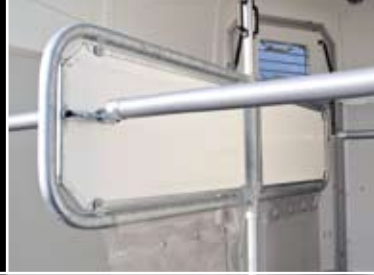
Geteilte Mitteltrennwand aus Holz und Weich-PVC – individuell anpassbar
