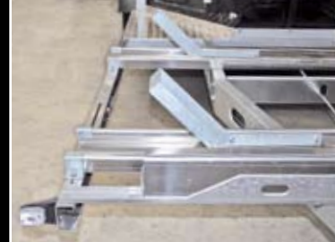
Zwei von 650 bis 1330 mm verstellbare Standschienen aus Aluminium
