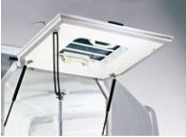
Vordere Schrägen an der GFK-Polyhaube mit Ausstellfenstern für den leichten Ausstieg
