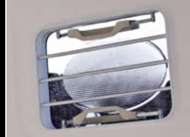
Getönte 5-fach verstellbare Ausstellfenster mit Sicherheitsstäben innen
