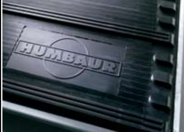
Gummimatte auf Heckklappe mit Trittschutz und seitlichem Wegrutschstopp
