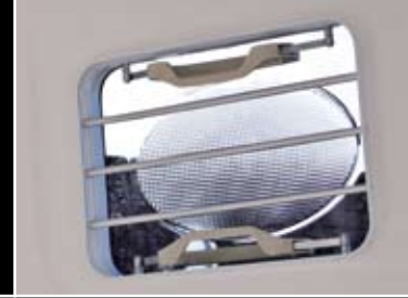
Getönte 5-fach verstellbare Ausstellfenster mit Sicherheitsstäben innen
