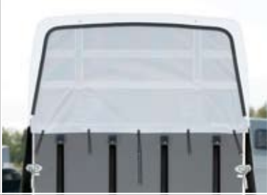
Polyhaube mit patentiertem WINDSCHOTT mit Easy-Roll-System
