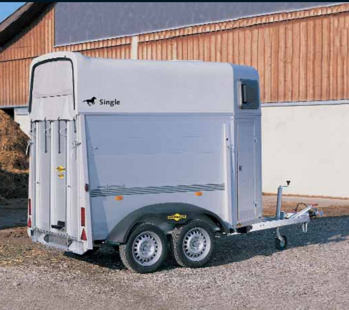
Abb. links Single Alu mit doppelwandigen Seitenwänden und eloxiertem Aluminiumboden
