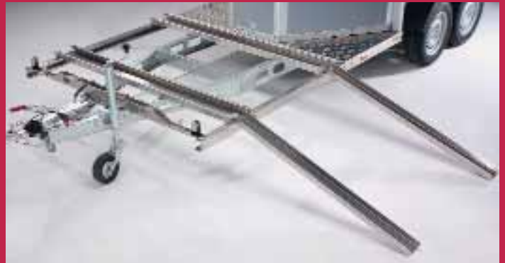
Auffahrsschienen mit Rand verhindern das seitliche Abrutschen der Kutsche
