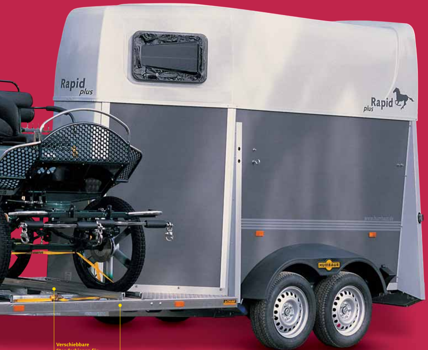
Stabile Halterung für Kutschenstandschienen, aus gekanteten Profilen
