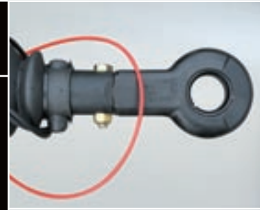
DIN-Zugöse für höhenverstell- bare Zugdeichsel
