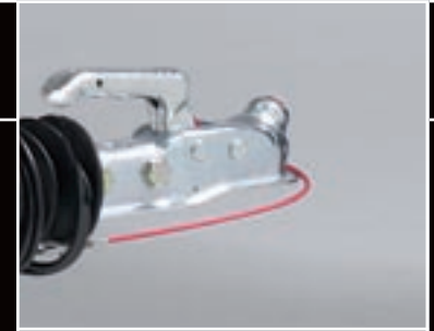
Kugelkopfkupplung für höhen- verstellbare Zugdeichsel
