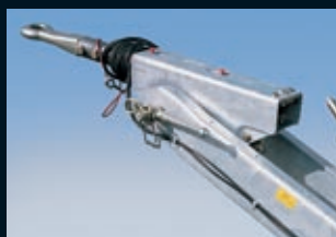
Höhenverstell- bare Zugdeichsel mit DIN-Zugöse anstelle von Kugel- kopfkupplung
