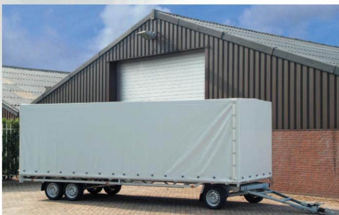
▲ Die Hochplane ist rundum zu öffnen, das Mittelrohr ist herausnehmbar
