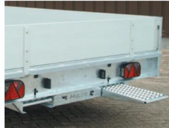
▲ Die Auffahrampen werden in Haltern unter dem Rahmen transportiert
